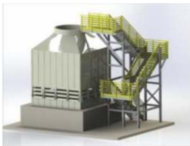
Aplicação de escada inclinada para acesso de inspeção ao acionamento mecânico do equipamento.
